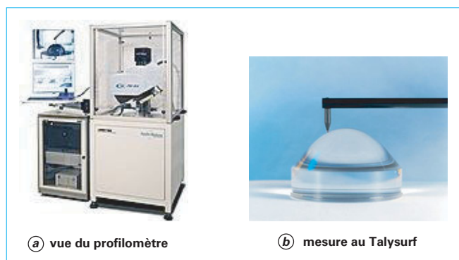
Figure 23 – Profilomètre mécanique Talysurf (source : Taylor Hobson)
