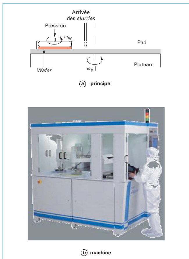
Figure 22 – Principe du CMP et exemple de machine
