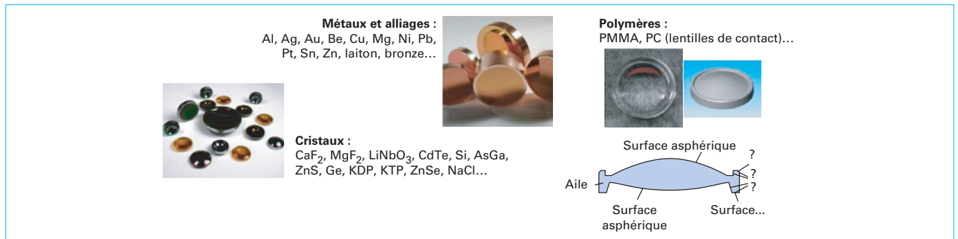
Figure 5 – Matériaux usinables avec la technologie SPDT
