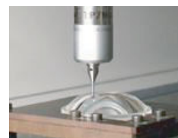
(d) lentille plastique en mesure
