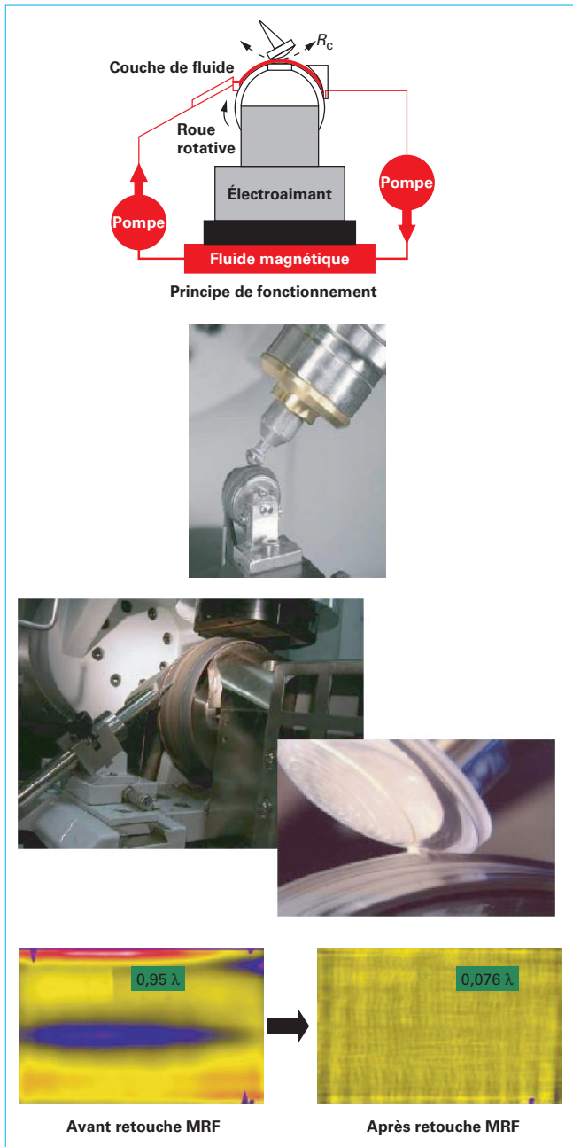
Figure 13 – Principe du polissage par MRF (société QED)
