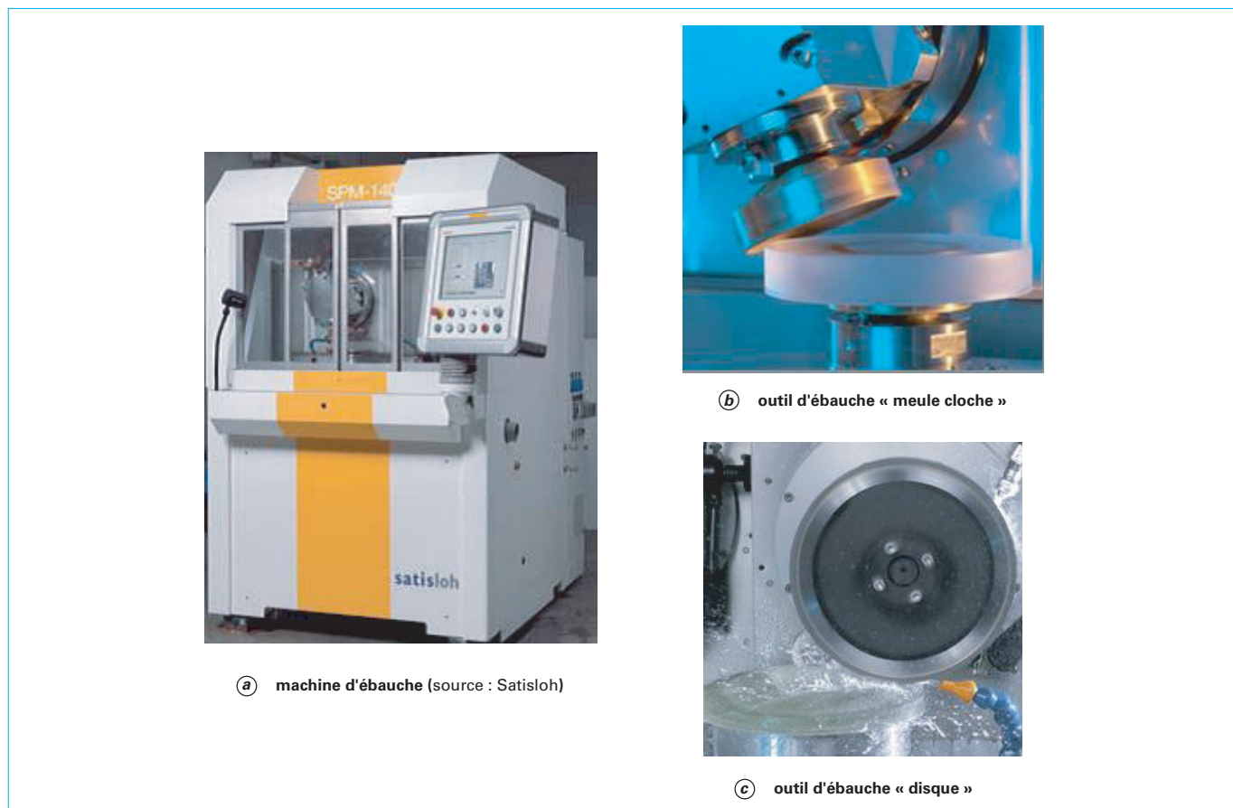
Figure 9 – Exemple de machine d'ébauche et outils associés
